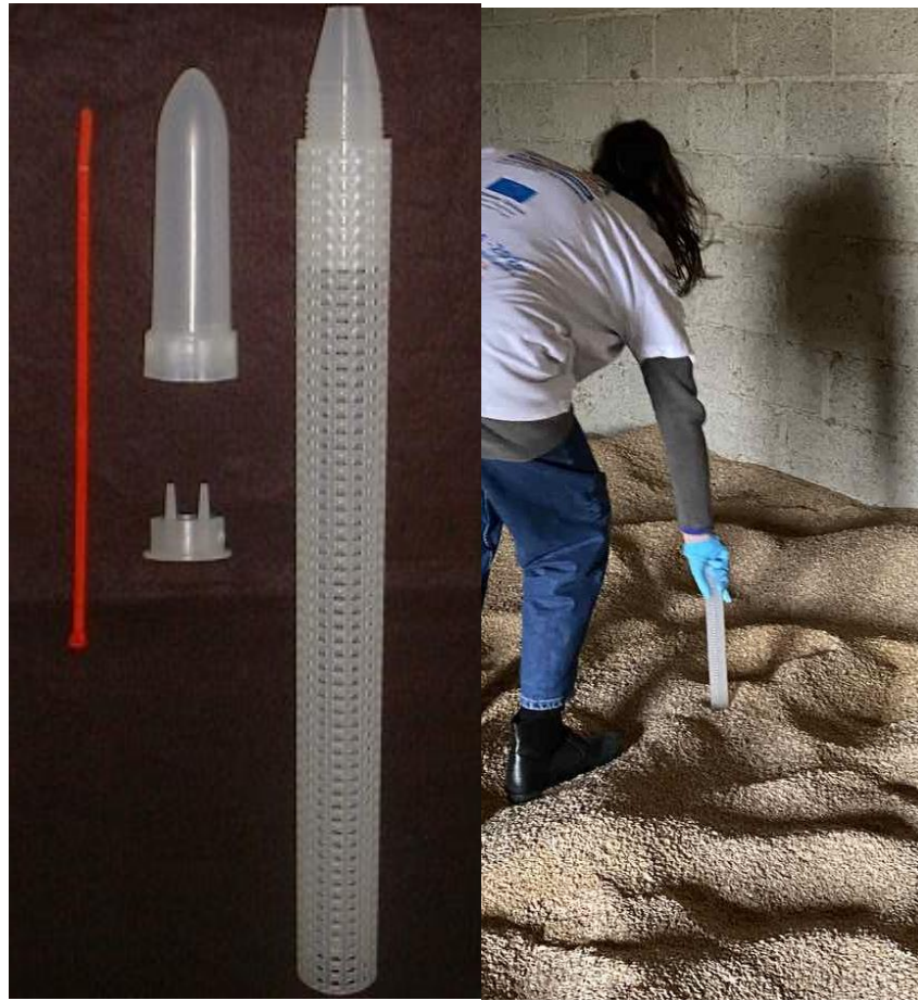
Εικόνα 8: Παγίδα τύπου σόντας (αριστερά) και τοποθέτηση παγίδας σε χύδην σιτάρι (δεξιά) [Πηγή: http://www.chemtica.com/site/wp-content/uploads/2012/08/trapgrainprobe-300x205.jpg (αριστερά) και Εργαστήριο Εντομολογίας και Γεωργικής Ζωολογίας (δεξιά)]
